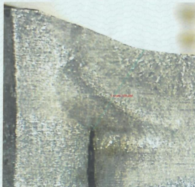
شکل 23. تصویر ماکروسکوپی از مقطع عرضی آماده سازی شده. (مقطع 23) محلول ظاهر کننده: نایتال ده درصد
