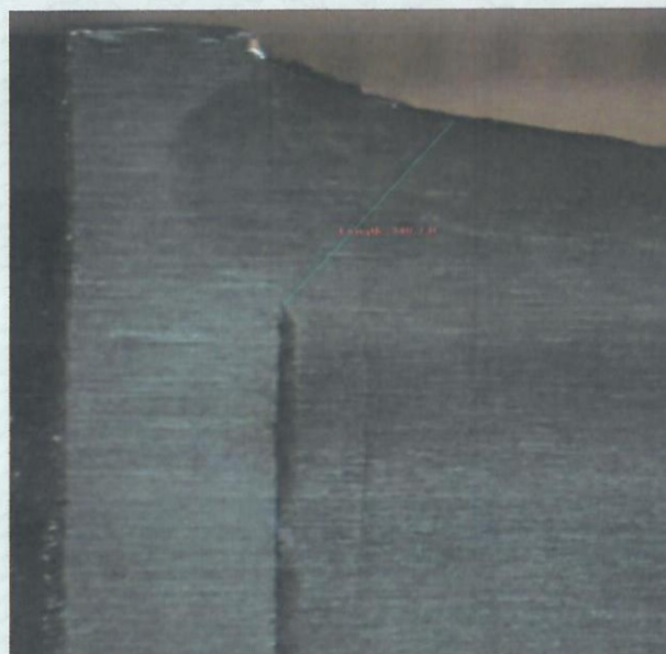
شکل 4. تصویر ماکروسکوپی از مقطع عرضی آماده سازی شده. (مقطع 4) محلول ظاهر کننده: نایتال ده درصد
