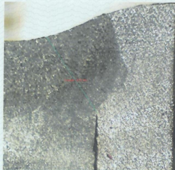
شکل 18. تصویر ماکروسکوپی از مقطع عرضی آماده سازی شده. (مقطع 18) محلول ظاهر کننده: نایتال ده درصد
