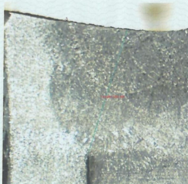
شکل 17. تصویر ماکروسکوپی از مقطع عرضی آماده سازی شده. (مقطع 17) محلول ظاهر کننده: نایتال ده درصد
