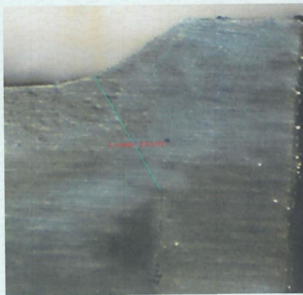
شکل 38. تصویر ماکروسکوپی از مقطع عرضی آماده سازی شده. (مقطع 38) محلول ظاهر کننده: نایتال ده درصد
