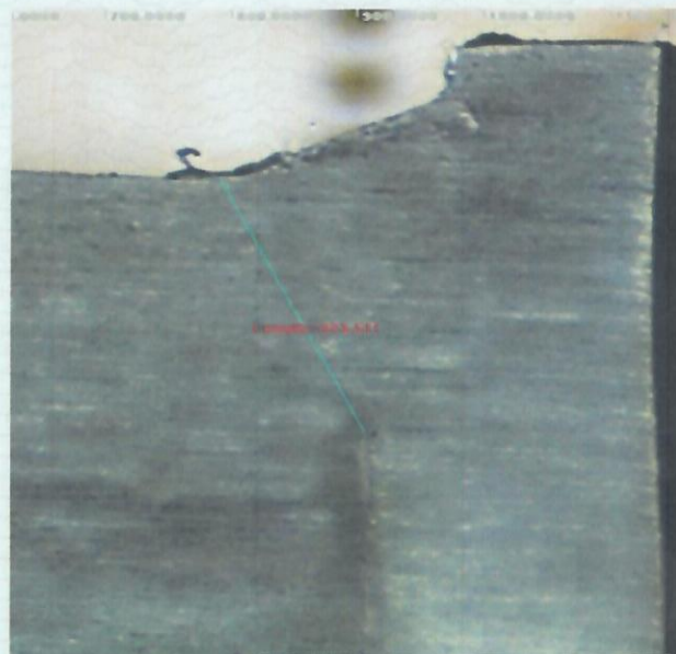
شکل 40. تصویر ماکروسکوپی از مقطع عرضی آماده سازی شده. (مقطع 40) محلول ظاهر کننده: نایتال ده درصد
