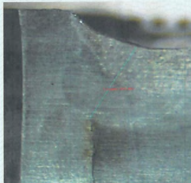
شکل 35. تصویر ماکروسکوپی از مقطع عرضی آماده سازی شده. (مقطع 35) محلول ظاهر کننده: نایتال ده درصد
