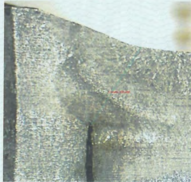
شکل 23. تصویر میکروسکوپی از مقطع عرضی آماده سازی شده. (مقطع 23) محلول ظاهر کننده: نایتال ده درصد
