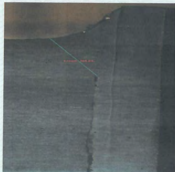
شکل 9 تصویر ماکروسکوپی از مقطع عرضی آماده سازی شده. (مقطع 9) محلول ظاهر کننده: نایتال ده درصد
