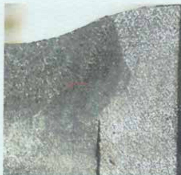
شکل 18: تصویر میکروسکوپی از مقطع عرضی آماده سازی شده (مقطع 18) محلول ظاهر کننده: تایتال ده درصد
