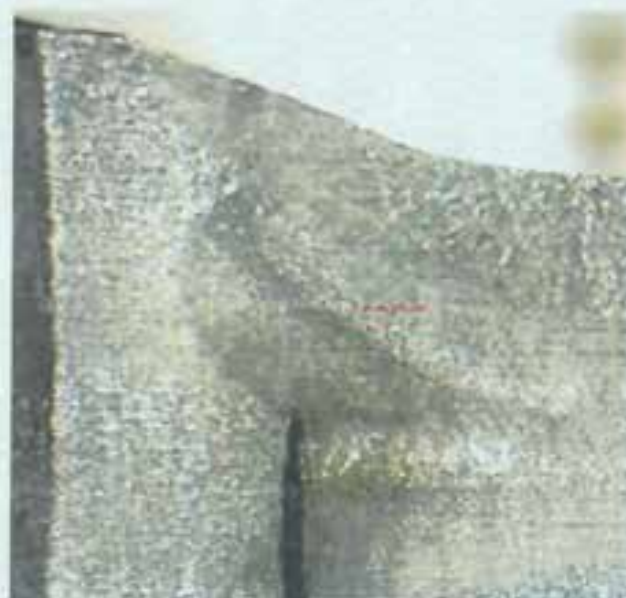
شکل 23 تصویر ماکروسکوپی از مقطع عرضی آماده سازی شده (مقطع 23) محلول ظاهر کننده نامتال ده درصد
