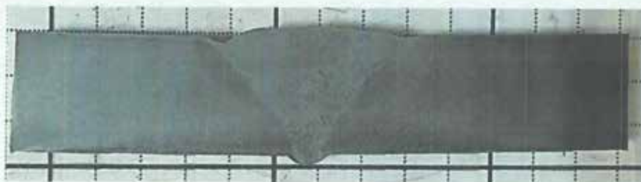
شکل ۱- تصویر ماکروسکوپی از مقطع عرضی آماده سازی شده محلول ظاهر کننده: نیترال ۵۵ درصد
