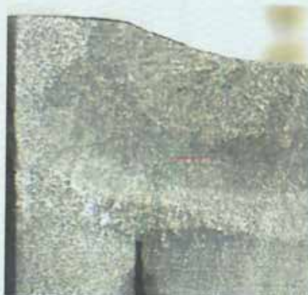
شکل 21: تصویر ماکروسکوپی از مقطع عرضی آماده سازی شده (مقطع 21) محلول ظاهر کننده: نایتال ده درصد
