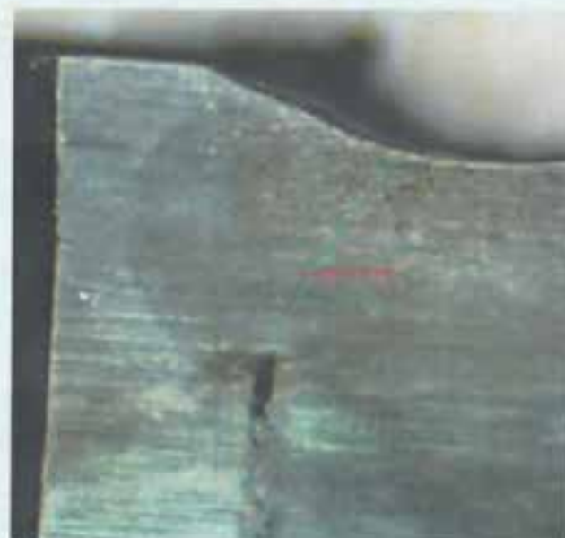
شکل 37. تصویر ماکروسکوپی از مقطع عرضی آماده سازی شده. (مقطع 37) محلول ظاهر کننده نامثال ده درصد
