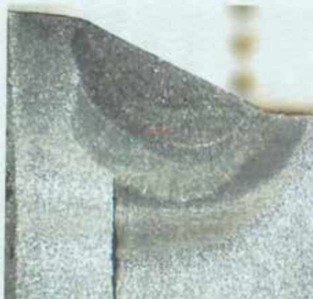
شکل ۱۶. تصویر میکروسکوپی از مقطع عرضی آماده سازی شده. (مقطع ۱۶) محلول ظاهر کننده: نایتال ده درصد
