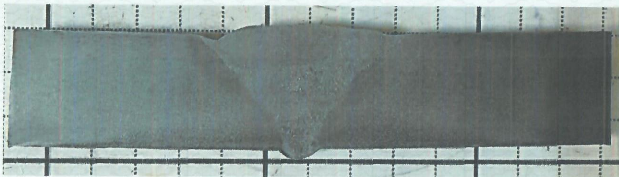
شکل ۱. تصویر ماکروسکوپی از مقطع عرضی آماده سازی شده. محللول ظاهر کننده؛ ناپتال ده درسد
