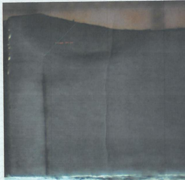
شکل 1. تصویر ماکروسکوپی از مقطع عرضی آماده سازی شده. (مقطع 1) محلول ظاهر کننده: نایتال ده درصد
