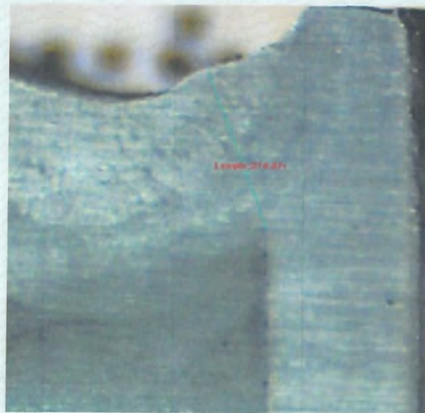
شکل 30. تصویر ماکروسکوپی از مقطع عرضی آماده سازی شده. (مقطع 30) محلول ظاهر کننده: نایتال ده درصد
