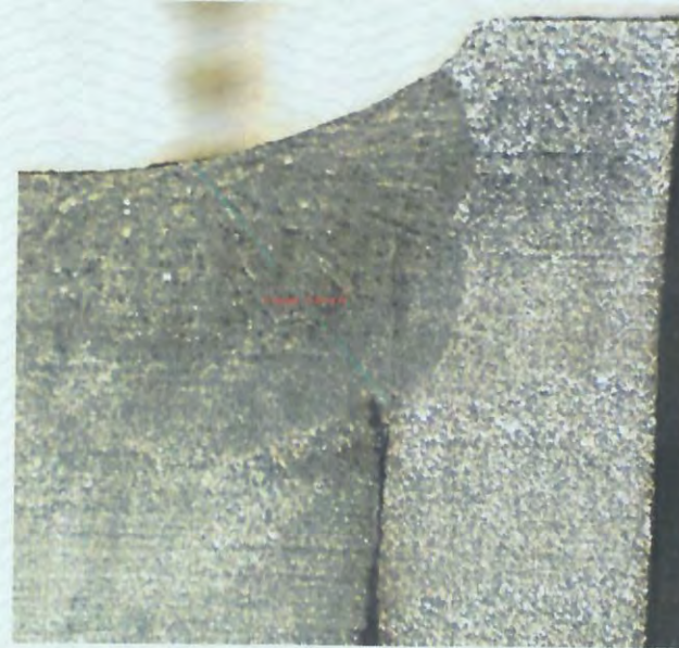
شکل 26. تصویر ماکروسکوپی از مقطع عرضی آماده سازی شده. (مقطع 26) محلول ظاهر کننده: نایتال ده درصد
