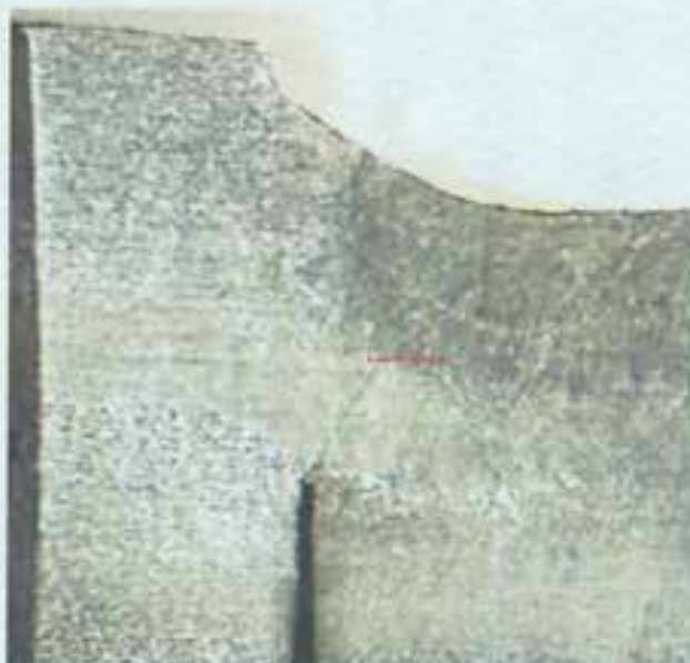
شکل 25 تصویر ماکروسکوپی از مقطع عرضی آماده سازی شده، (مقطع 25) محلول ظاهر کننده، نایتال ده درصد
