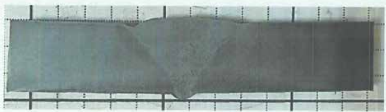
شکل 1 تصویر ماکروسکوپی از مقطع عرضی آماده سازی شده محلول ظاهر کننده: تایتال ۵۰ درصد
