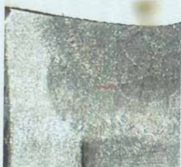
شکل ۱۷. تصویر ماکروسکوپی از مقطع عرضی آماده سازی شده. (مقطع ۱۷) محلول ظاهر کننده نایتال ده درصد
