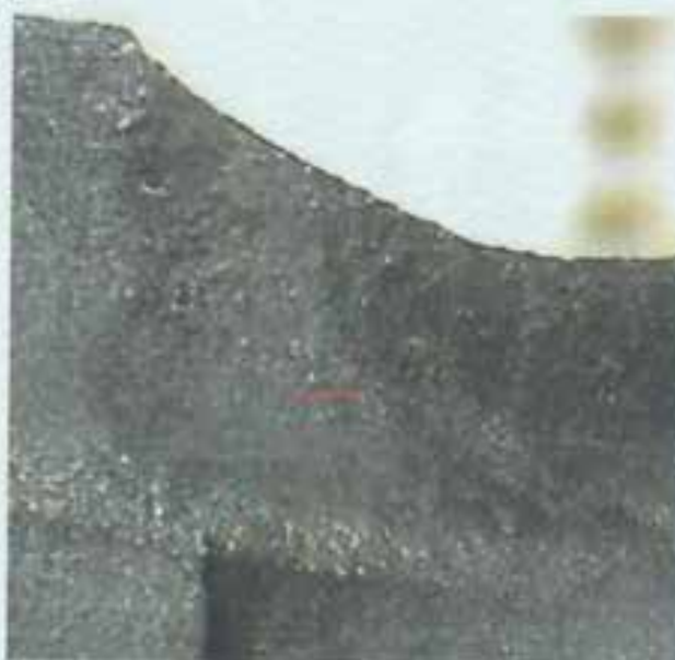
شکل 19 تصویر ماکروسکوپی از مقطع عرضی آماده سازی شده. (مقطع 19) محلول ظاهر کننده نایتال ده درصد
