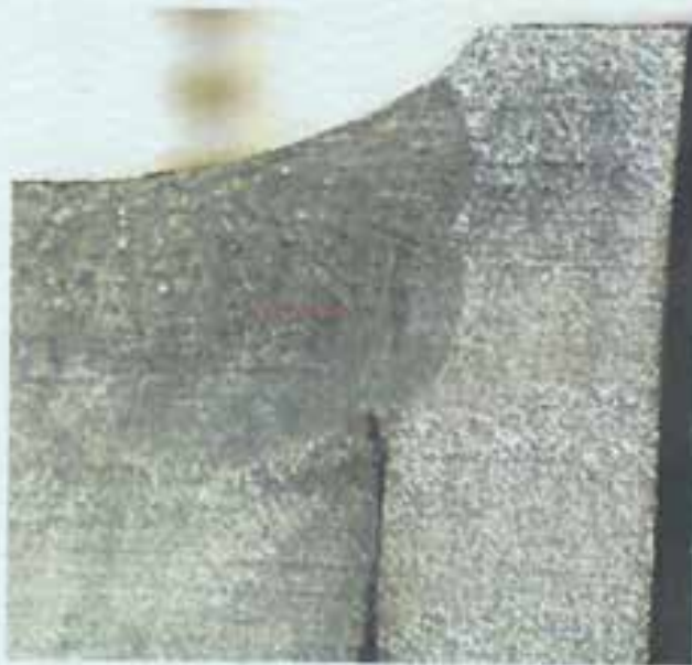
شکل 26 تصویر ماکروسکوپی از مقطع عرضی آماده سازی شده (مقطع 26) محلول ظاهر کننده، اپتال ده درصد
