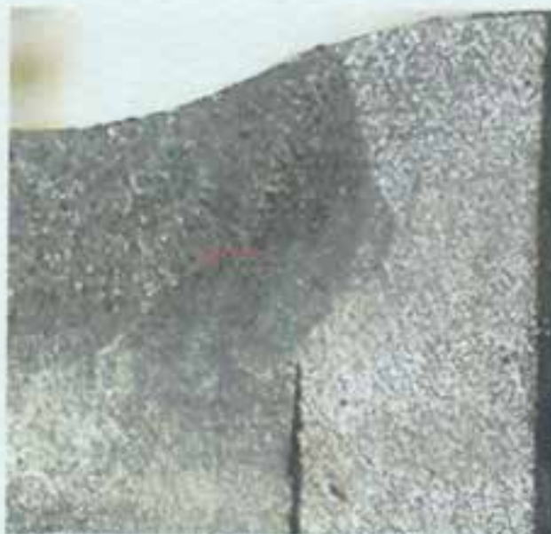
شکل 18: تصویر میکروسکوپی از مقطع عرضی آماده سازی شده (مقطع 18) محلول ظاهر کننده تاپتال ده درصد
