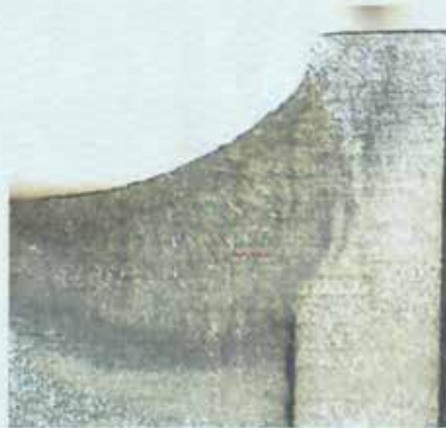
شکل 27: تصویر ماکروسکوپی از مقطع عرضی آماده سازی شده. (مقطع 27) محلول ظاهر کننده: نایتال ده درصد
